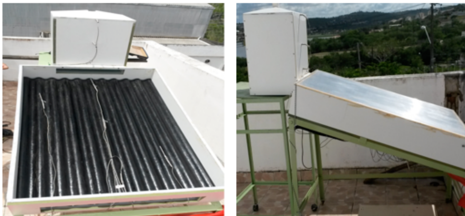
Figura 1. Fotos do Sistema de Secagem Solar no solarium do LEMT/UFCG, com destaque para placa adsorvedora da radiação solar.
